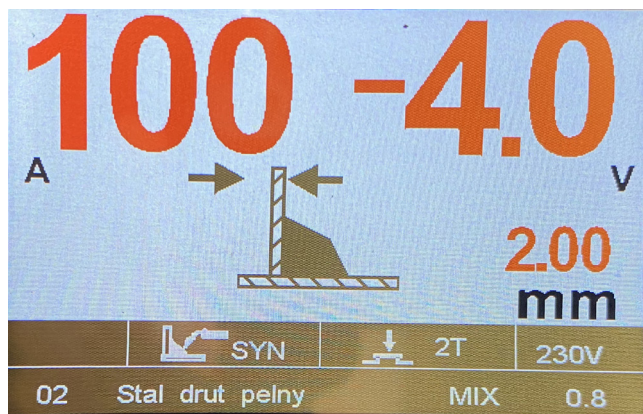
Rysunek 14: Ustawienia parametrów spawania wg programów synergicznych (w tym przykładzie wybrano: program 02, spoinę pachwinową PB, tryb 2T, prąd spawania 100A, korektę napięcia minus 4,0V. Odpowiada to parametrom spawania blach stalowych grubości ok. 2 mm. Wpływ korekty napięcia na kształt spoiny ilustrowany jest przez zmiany zacienionego pola).
